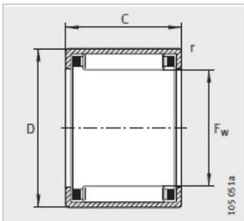
闭式冲压外圈滚针轴承：
