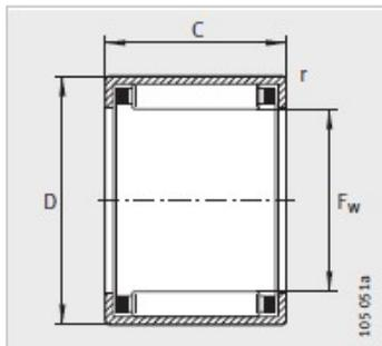
闭式冲压外圈滚针轴承：
