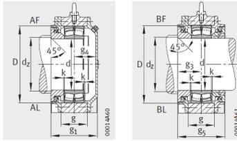
设计类型 A 带有 Taconite 密封的轴承座
